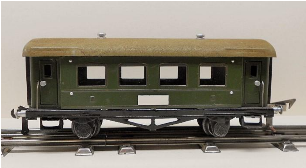
Personenwagen 2achsiger, grün Kat.nr. PW2 Nr. 21201 Sonderausführung, eine Seite Normalkupplung andere Seite Automatikkupplung, sonst wie die Normalausführung (Detailbild im Sonderteil)
