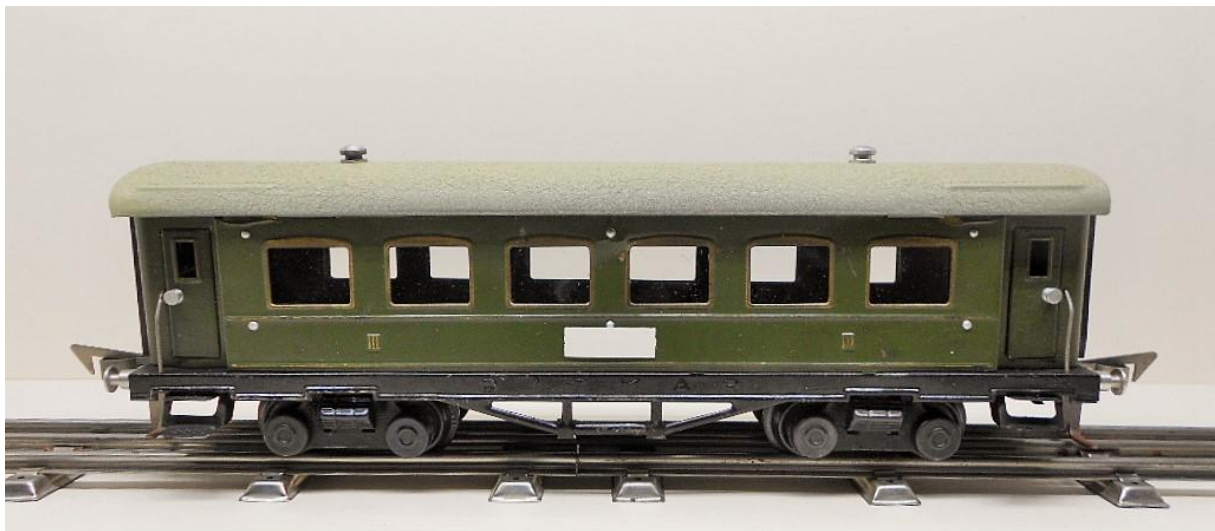
Personenwagen 4achsiger, grün Kat.nr. SW4 Nr. 21403 "3" Klasse am Wagenkasten hochgeprägt, steckbare Fensterverglasung aus Cellon
