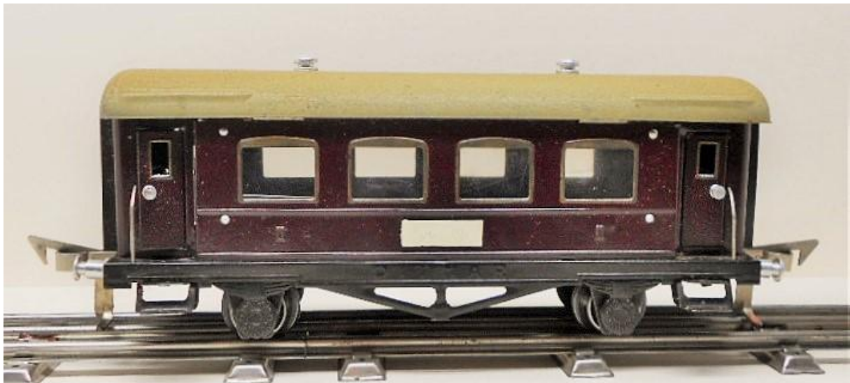
Personenwagen 2achsrig, weinrot Kat.nr. PW2 Nr.21 200 "2" Klasse am Wagenkasten hochgeprägt, Fensterverglasung aus Cellon gesteckt
