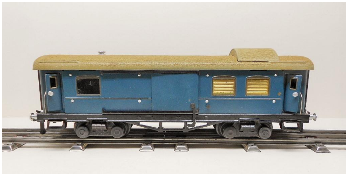
Packwagen 4achsig, blau Kat. nr. PW4 Nr. 21 500 2 Schiebetüren mit Überwurfriegel, Packabteil mit messingfarbenen Riffelblechen abgedeckt, steckbare Fensterverglasung
