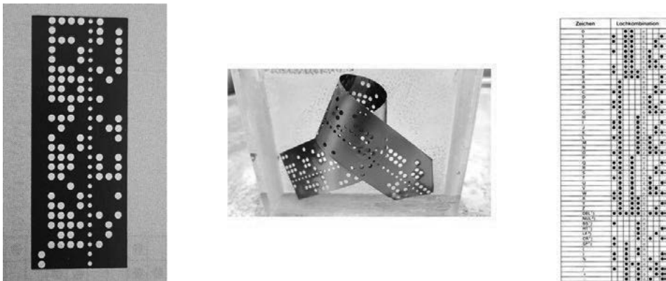
Bild 1.2 Lochstreifen von NC-Maschinen mit einer Code-Tabelle
