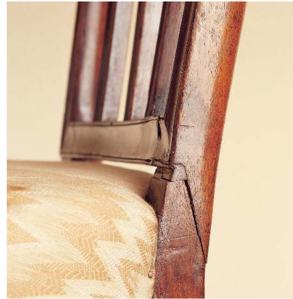
Größere Strukturschäden, wie etwa eine gebrochene Rückenlehne, bedürfen der Restaurierung, nicht etwa der Konservierung.
