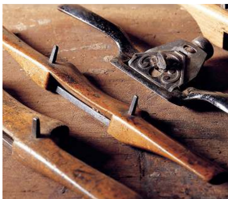
Der Schabhobel, eine Kreuzung aus Hobel und Ziehklinge (Schaber), hat sich beim Formen von Holz als vielseitiges Werkzeug bewährt.
