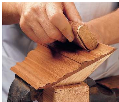
Dem Profil angepasste Schleifklötze, die in Verbindung mit Schleifpapier zum Glätten von Zierleisten dienen.
