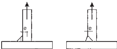
b) Zugkraft erzeugt Zug in der Schweißnahtwurzel
