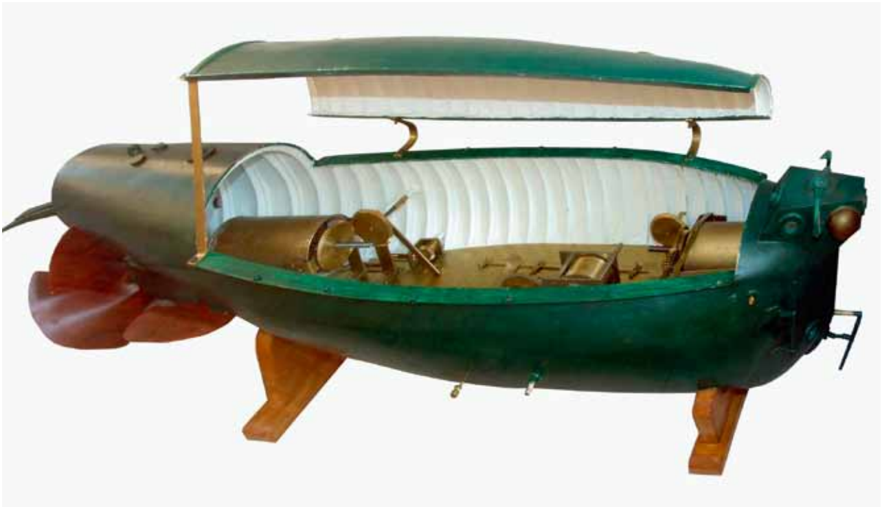
Das Funktionsmodell eines Tauchboots (Modellbau Sellmer, Kiel 1999) ist der Nachbau eines Vorführmodells, mit dem Wilhelm Bauer in den Jahren von 1853 bis 1855 arbeitete, um Kunden für seine neue Tauchboot-Technik zu akquirieren. 1856 wurde dieser Typ in St. Petersburg nach seinen Plänen gebaut und unter dem Namen »Seeteufel« erfolgreich erprobt.
