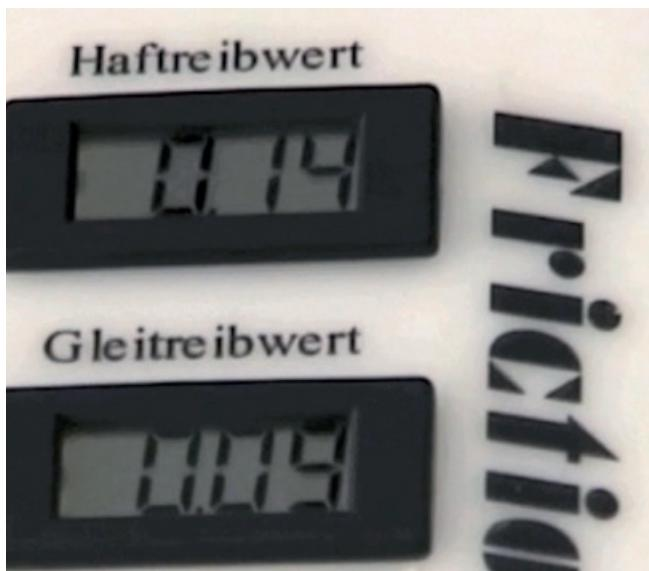
Der angezeigte (gemessene) Wert von 0,14 bedeutet, dass ein Körper mit 50 kg, an dieser Stelle bei den gegebenen Oberflächenarten eine Haftkraft von maximal 7 kp erzeugen kann, bevor er „rutscht“.
