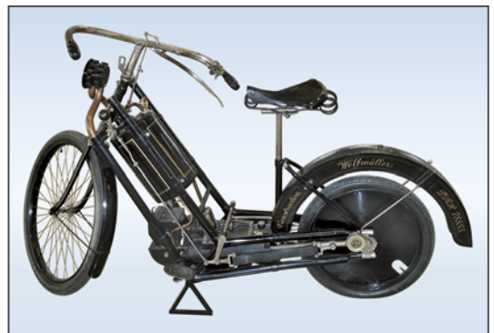
Bild 3: Das Hildebrand- und Wolfmüller-Motorrad mit Glühzündung
