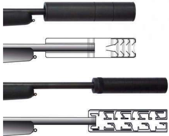
Abb. 8.8: Einfache Dämpferkonstruktionen (unten) erhöhen die Gesamtlänge in einem größeren Umfang als Teleskopdämpfer (oben).
