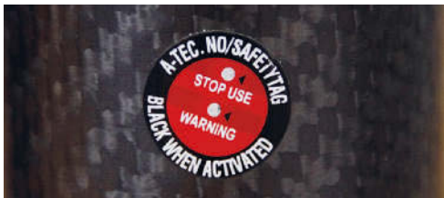
Abb. 8.6: A-TEC versieht seinen CarbonO 2 mit einem Sicherheitsfeld, das eine Überhitzung anzeigt. Verfärbt sich das »STOP USE«-Feld, ist die Carbonhülle irreparabel geschädigt und muss ausgetauscht werden.
