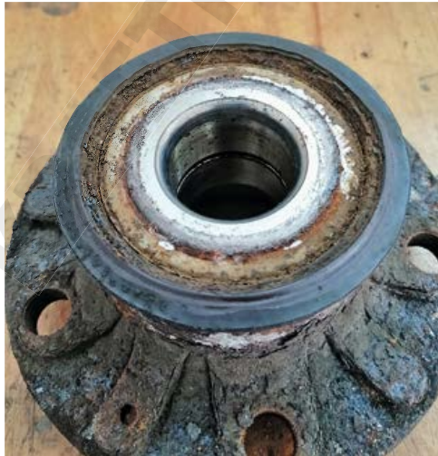
Durchgeschliffen: Durch die aufgequollenen ABS-Sensorringe wurden die ABS-Sensoren beschädigt. Bild: Oppl
