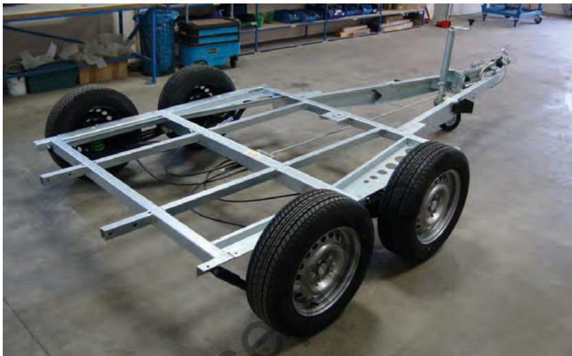
Bild 7: Das industriell gefertigte Komplettfahrgestell ist die beste Basis für einen Anhängerselbstbau.
