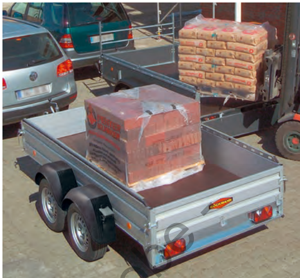
Bild 3: Ein solcher Transportanhänger in Tandemachsbauart hat bei einem Leergewicht von etwas mehr als 400 kg fast 1.600 kg Nutzlast.
