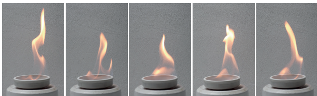
Bild 4: Brennbare Flüssigkeiten verbrennen normalerweise nur unter Flammenerscheinung, bei unvollständigen Verbrennungen tritt auch eine Rußbildung auf. (Quelle: Roy Bergdoll)
