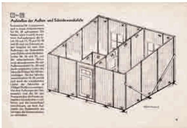
Aufbauanweisung für ein Behelfsheim Typ DWH 1001 von 1943: Aufstellen der hölzernen Wandelemente.
