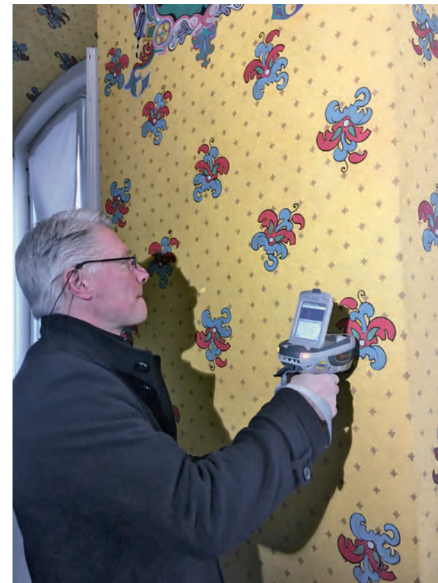
Abb. 8 Schloss Branitz, Türkisches Zimmer, Untersuchung der Verteilung schwermetallbelasteter (giftiger) Pigmente mittels mobiler Röntgenfluoreszenzanalyse durch Prof. Dr. Steffen Laue, Foto: BLDAM, Mechthild Noll-Minor, 2019
