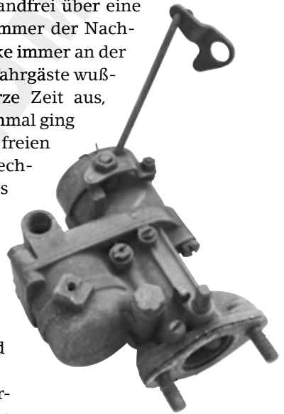
Solex 26 VFIS: Verbaut u.a. im 24-PS-Käfer. Bild: Blenk
