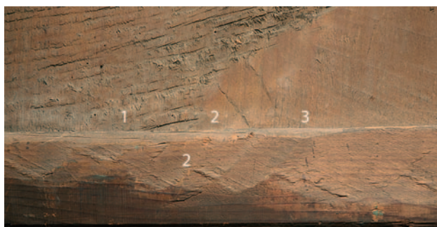
2 Detail Rückseite, Werkspuren aufTafel und Gratleiste: 1 – Sägespuren, 2 – grobe Zuarbeit mit einem Beil, 3 – Glättung mit einem flachen Eisen
