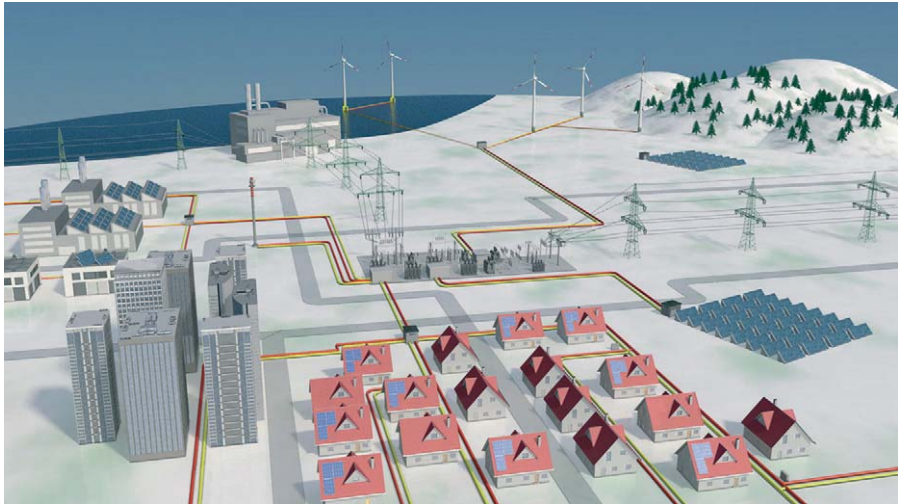
Bild 4.1 Die Ortsnetzstation als Bindeglied zwischen Mittel- und Niederspannung
