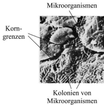
Abb. 1.5 Besiedlung durch Mikroorganismen auf einer Edelstahloberfläche.
