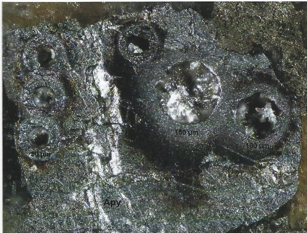
Abb. 23 Probe 005. Arsenkies-Einkristall in Matrix. Kratergrößen der Laser-Ablation: Serie B, links: 50 µm. Serie A, rechts: 50 µm, 150 µm und 100 µm
