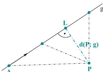
Asteroid genau dort den geringsten Abstand von der Erde, wo die Verbindungsstrecke Erde – Asteroid einen rechten Winkel mit der Geraden der Flugbahn bildet (siehe Abbildung). Diesen Geradenpunkt, der den kleinsten Abstand aller Geradenpunkte vom Punkt P hat, bezeichnet man als den **Lotfußpunkt L** des Punktes P auf der Geraden g.
