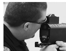
Abb. 186: Verkehrsradar Die Frequenz f_E , die ein mit der Geschwindigkeit v fahrendes Auto reflektiert, ergibt sich aus der Senderfrequenz f_S bei elektromagnetischen Wellen stets zu
