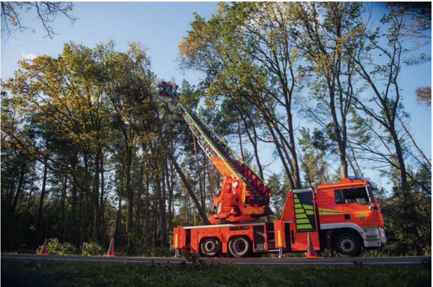
Bild 2: Technische Hilfeleistung: Hubrettungsfahrzeuge außerhalb des Fallbereiches von herabstürzenden Teilen positionieren, möglichst mit weiter Ausladung über das Fahrzeugheck arbeiten. (Bild: Phillip Schulze)
