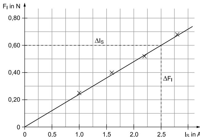
Im Rahmen der Mess- und Zeichengenauigkeit liegen die zu den Messwerten gehörenden Punkte im  $I_S$ - $F_I$ -Diagramm auf einer Ursprungsgeraden. Daraus folgt:
