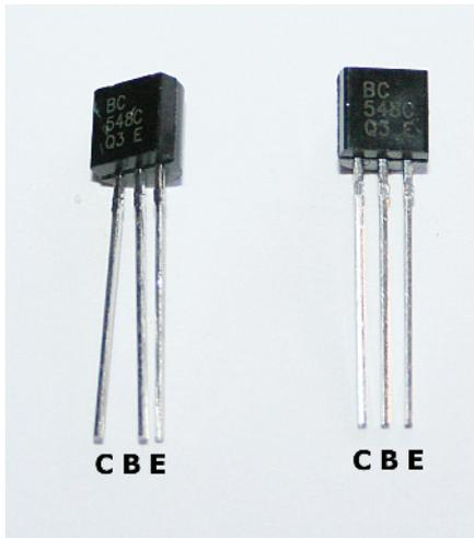
**Abbildung 1.4:** Zwei einfache Kleintransistoren mit Kennzeichnungen der Anschlüsse
