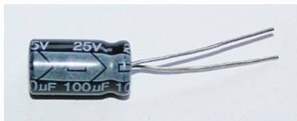
**Abbildung 1.3:** Ein Elektrolytkondensator mit Kapazitätsangabe und Maximalspannung
