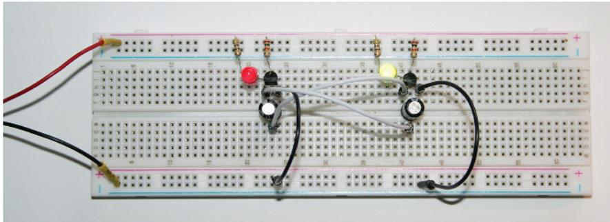
**Abbildung 1.9:** Der Aufbau des Wechselblinkers auf dem Steckboard
