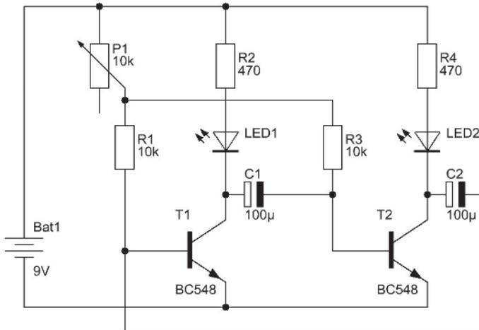
**Abbildung 1.12:** Schaltbild des Wechselblinkers mit einstellbarer Blinkfrequenz
