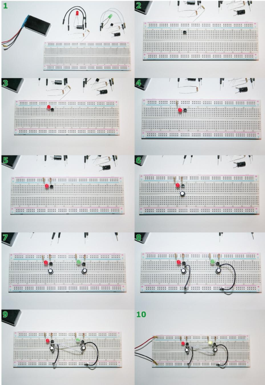
**Abbildung 1.10:** Schrittweiser Aufbau der Blinkerschaltung auf dem Steckboard
