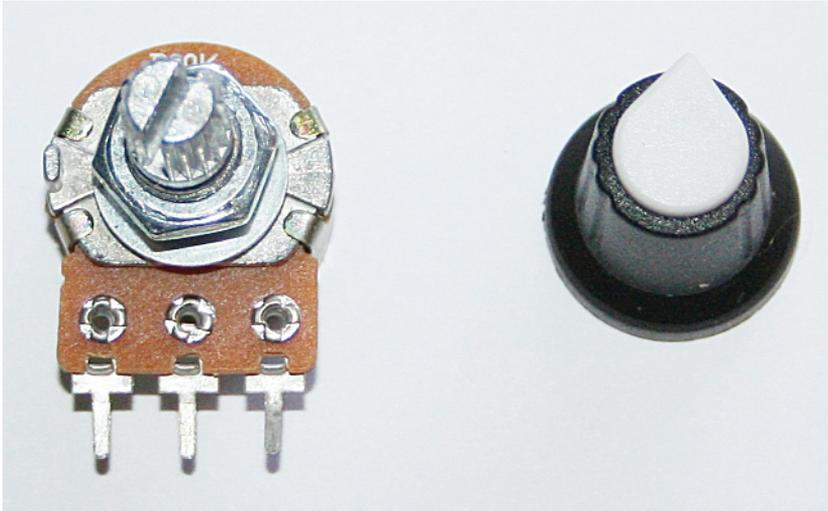
**Abbildung 1.11:** Ein Potenziometer beziehungsweise Poti mit passendem Drehknopf
