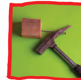
Praktisch zum Herausziehen von Nägeln: ein Klauenhammer
