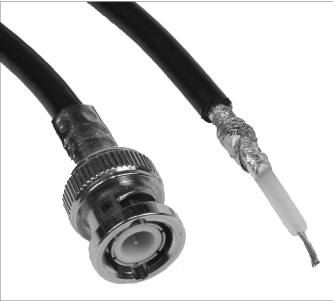
Abbildung 2.2 BNC-Stecker und Koaxialkabel Cheapernet (10Base-2)
