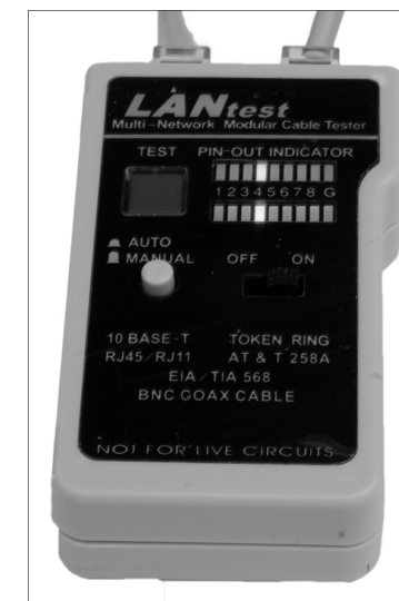
Abbildung 2.26 Prüfung der Patchkabel
