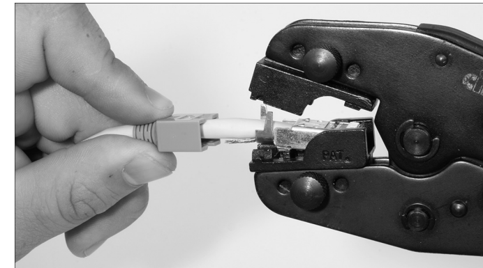
Abbildung 2.23 Einführen des RJ45-Steckers in das Crimpwerkzeug
