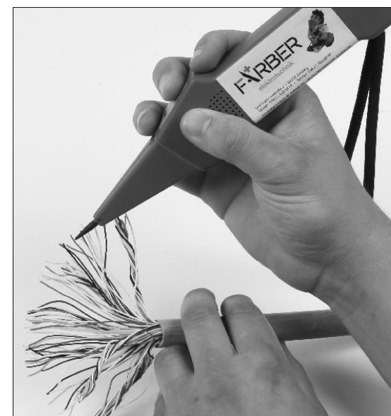
Abbildung 2.30 Arbeiten mit dem Tastkopf an einem Adernbündel
