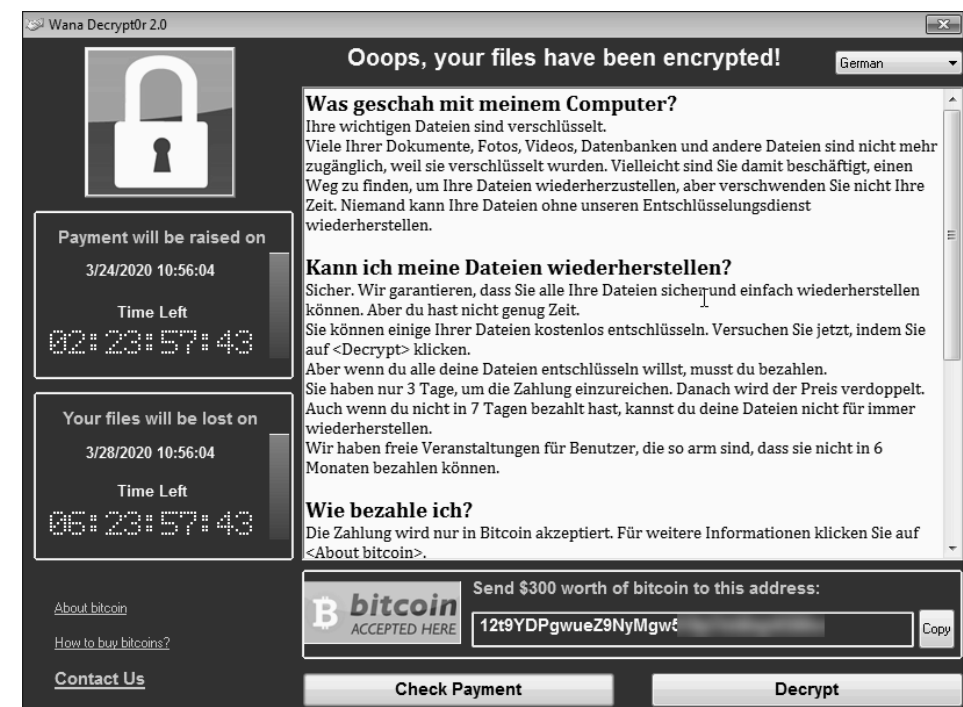
Abbildung 2.7 Benachrichtigung einer Ransomware, dass die Dateien auf dem System verschlüsselt worden sind
