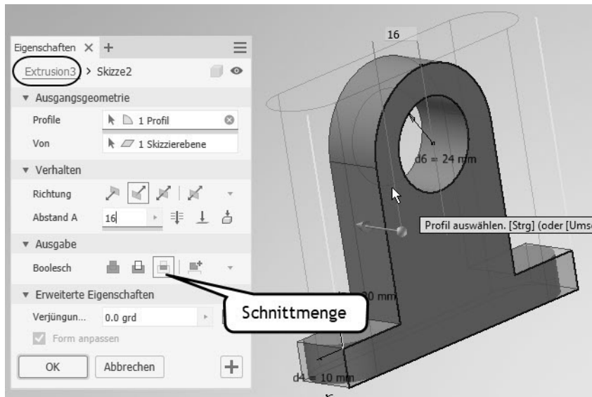
Abb. 1.36: Extrusion des zweiten Profils, Zusammenfügung mit der ersten Extrusion mit der Operation SCHNITTMEASSE
