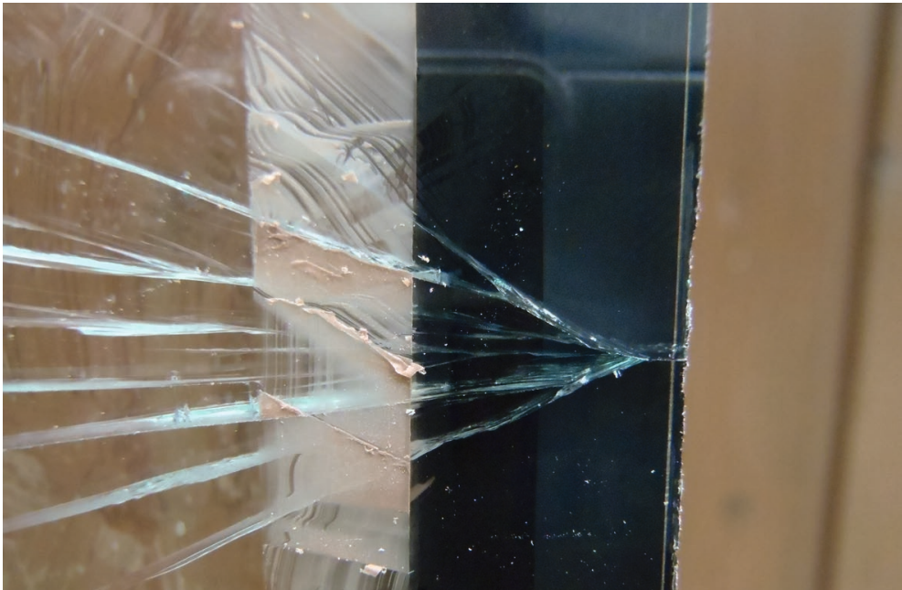
Thermischer Palmsprung, der durch sehr starke punktförmige Erhitzung der Scheibe entstanden ist. Deutlich erkennbarer rechtwinkliger Einlauf zur Glaskante mit sofortiger Aufspaltung, da sehr hohe Spannungen einwirkten.
