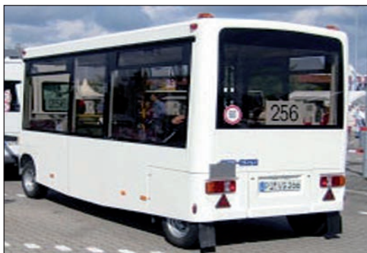
Illustration 2 : Remorque de bus pour utilisation derrière un minibus
