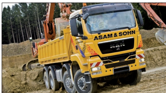
Illustration 2 : Véhicule de chantier avec concept d'entraînement 8x8/4
