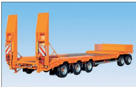
Illustration 1 : Remorque spéciale en tant que remorque surbaissée pour le transport de véhicules
