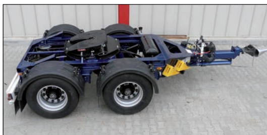
Illustration 4 : Dolly avec suspension à air comprimé
