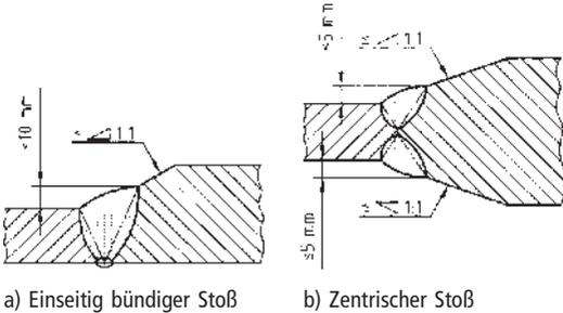
**Bild NA.3.** Beispiele für das Brechen von Kanten bei Stumpfstößen von Querschnittsteilen mit verschiedenen Dicken
