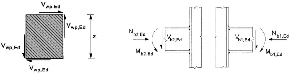
a) Schubkäfte im Stützenstegfeld                      b) Verbindungen mit den Schnittgrößen der angeschlossenen Träger
