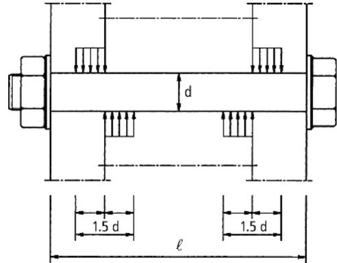
**Bild 3.6.** Begrenzung der effektiven Länge von langen Injektionsschrauben
