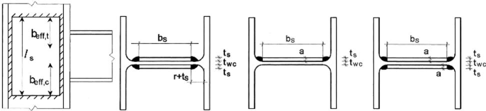
a) Anordnung b) Beispiele für Querschnitte mit Längsnähten
