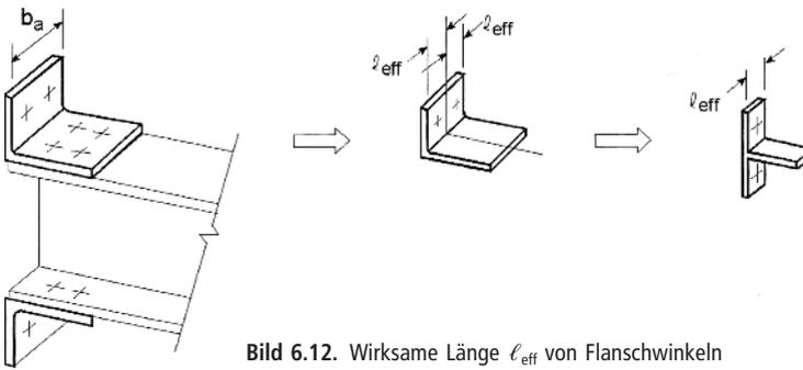
Bild 6.12. Wirksame Länge  $\ell_{\text{eff}}$  von Flanschwinkeln
