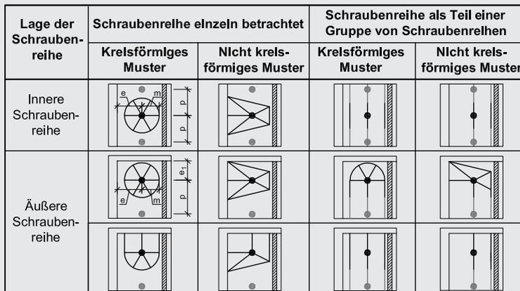
Bild K10. Fließmuster für einen nicht ausgesteiften Stützensgurt
