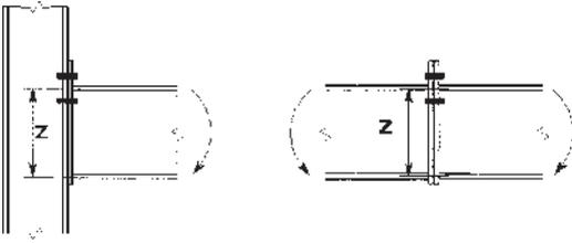
Bild 6.20. Hebelarm  $z$  für das vereinfachte Verfahren
