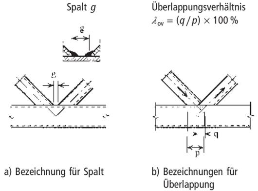
**Bild 1.3.** Knotenanschlüsse mit Spalt und mit Überlappung
