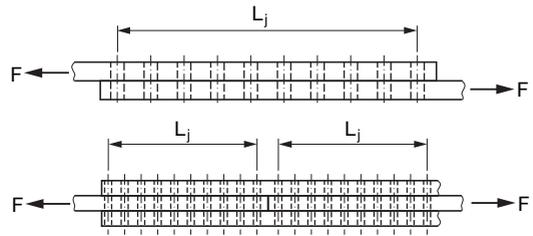
Bild 3.7. Lange Anschlüsse
