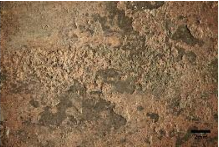
Abb. 3: Mikroskopaufnahme der schwarzen Ablagerungen im Kupferblech, Kat. Nr. 1027
