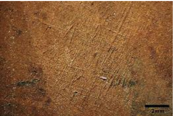
Abb. 6: Mikroskopaufnahme mit plastisch aus dem Blech heraustretenden Abdrücken eines Werkzeuges, Kat. Nr. 2039
