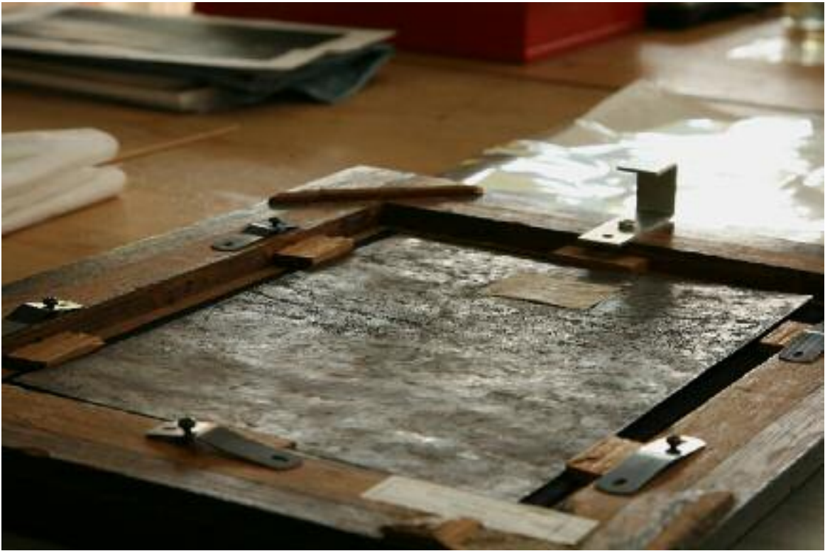
Abb. 2: Unebene Struktur des Kupferbleches im Reflexlicht, Kat. Nr. 1027
