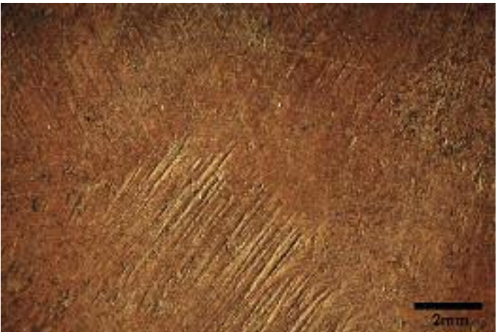
Abb. 5: Mikroskopaufnahme von Riefen im Kupferblech, die später von einem glatten, runden Hammer nivelliert wurden, Kat. Nr. 1694
