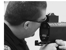
Abb. 186: Verkehrsradar Die Frequenz f_E , die ein mit der Geschwindigkeit v fahrendes Auto reflektiert, ergibt sich aus der Senderfrequenz f_S bei elektromagnetischen Wellen stets zu
