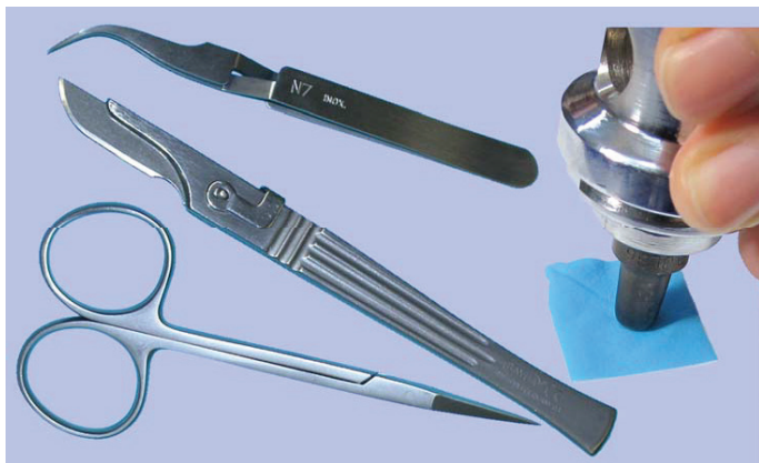
Bild 3.5 Probenentnahme durch Schneiden oder Stanzen ohne Quetschen oder Erwärmen der Probe, auf scharfes Werkzeug ist zu achten, möglichst ausschließlich Berührung der Probe mit einem sauberen Skalpell
