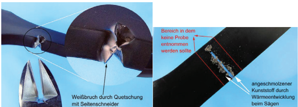
Bild 3.6 Schädigung von Kunststoffproben bei der Probenentnahme
