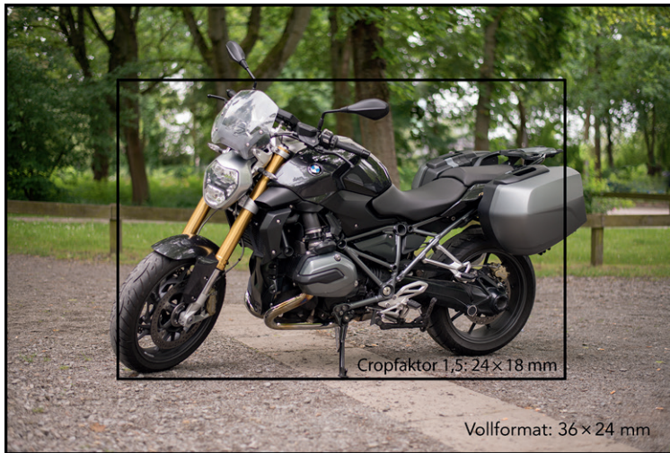
Abb. 2–6 Der große Rahmen zeigt an, welchen Bildbereich ein Vollformatsensor mit 36 \times 24 mm Kantenlänge erfasst. Der kleine Rahmen zeigt den Bildbereich an, der bei gleicher Brennweite von einem kleineren Sensor erfasst würde. Die BMW R 1200 R wirkt bei der Kamera mit kleinerem Sensor in den Bildrahmen eingequetscht. Da der kleinere Sensor (Crop-Faktor 1,5) das Motorrad größer abbildet, spricht man von einer Brennweitenverlängerung: An einer Vollformatkamera hätten Sie den gleichen Bildausschnitt mit einer Brennweite von 75 mm erreicht ( 50 \text{ mm} \times 1,5 ) ( 50 \text{ mm} , 1/320 \text{ s} , f/1.8 , ISO 180).
