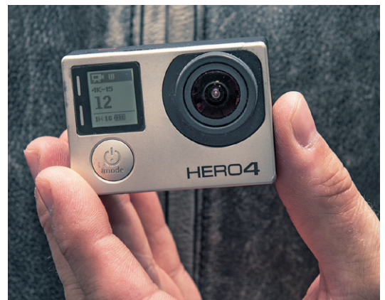
Abb. 2–9 Eine Actionkamera ist winzig und robust. Dank einer großen Auswahl an Befestigungsmöglichkeiten kann sie auf vielerlei Arten am Motorrad oder am Fahrer befestigt werden. Während sie ideal zum Filmen während der Fahrt sind, ist ihr Einsatz als Fotokamera nur beschränkt möglich.
