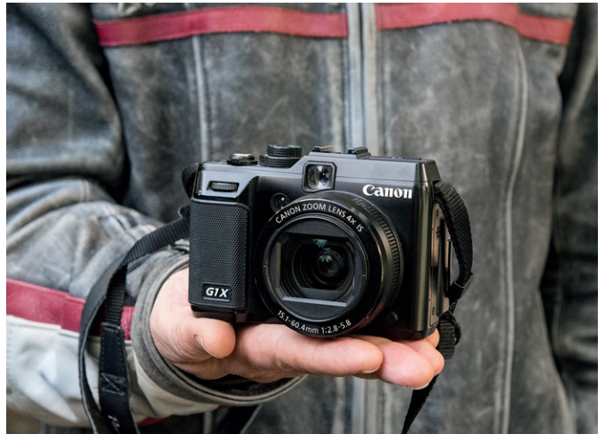
Abb. 2-3 Kompaktkameras sind leicht und handlich, jedoch kann man das Objektiv nicht wechseln (der geriffelte Ring an dieser Kamera ist ein Designelement, das Objektiv ist fest verbaut). Die Ansteuerung externer Blitze ist außerdem nicht bei allen Modellen gegeben, wodurch Sie sich als Motorradfotograf stark einschränken würden.
