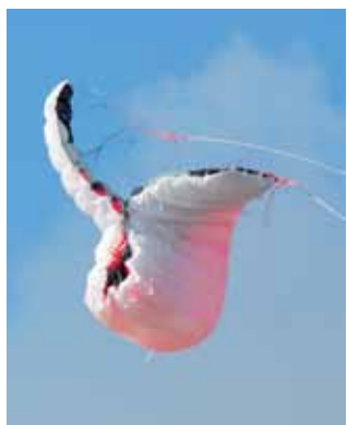
Matten können kollabieren. Hier wurde dieser Zustand allerdings zu Demonstrationszwecken absichtlich herbeigeführt. Foto: »Symphony Speed 2.5« [HQ-Kites]
