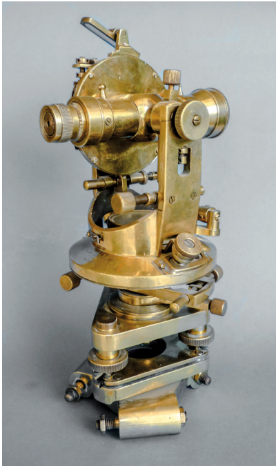
Abb. 1.13 Vermessung: Theodolit von Stanley, London 1940
