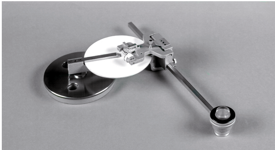
Abb. 1.10 Scheiben-Polarplanimeter der Fa. A. Ott, Kempten
