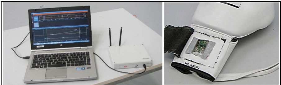
Abb. 2. Systemüberblick: PC mit Empfangsstation und Software (links), Handschuh mit Sensorik (rechts)
