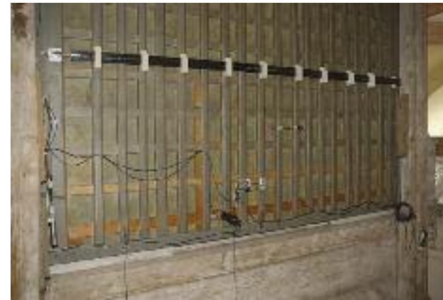
Abb. 5: Rückseite Cranachaltar mit Messpunkten für die Erfassung des Nahfeldklimas am Altar und der Gesamtbreite der Maltafel, Zustand vor der Restaurierung, erkennbar sind auch die Parkettierungsleisten, Foto: T. Löther, IDK
