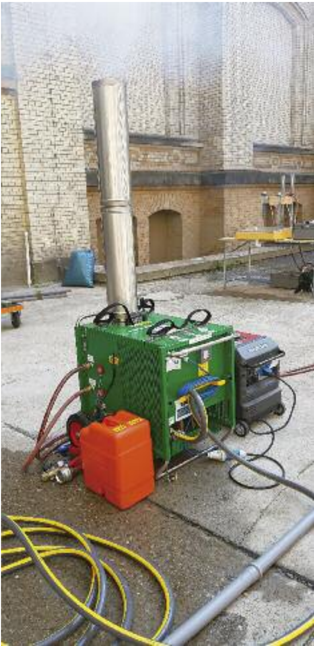
Abb. 4: Dieselbetriebenes Warmwassergerät im Probereinsatz, Foto: P. Giere
