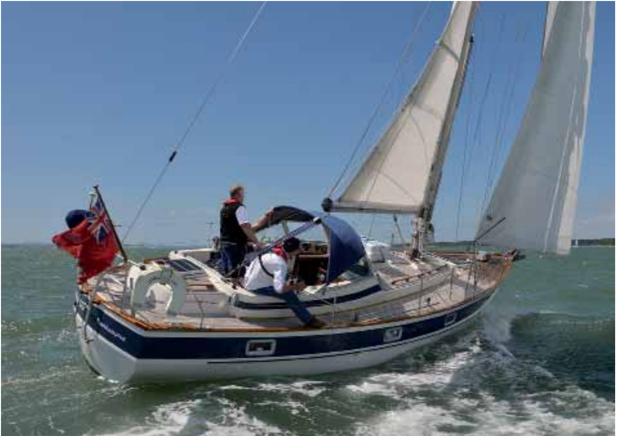
▲ Hoch am Wind, Genua-Holepunkt achtern, guter Trimm ▼ Raumer Wind, Genua-Holepunkt vorn, guter Trimm Fotos © Rick Buettner
