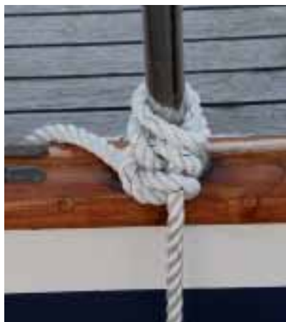
Fenderleine am Fuß der Relingsstütze mit einem Rundtörn mit zwei halben Schlägen befestigt
