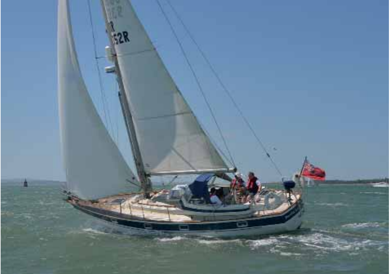
▲ Hoch am Wind, Genua-Holepunkt achtern, guter Trimm ▼ Raumer Wind, Genua-Holepunkt vorn, guter Trimm Fotos © Rick Buettner
