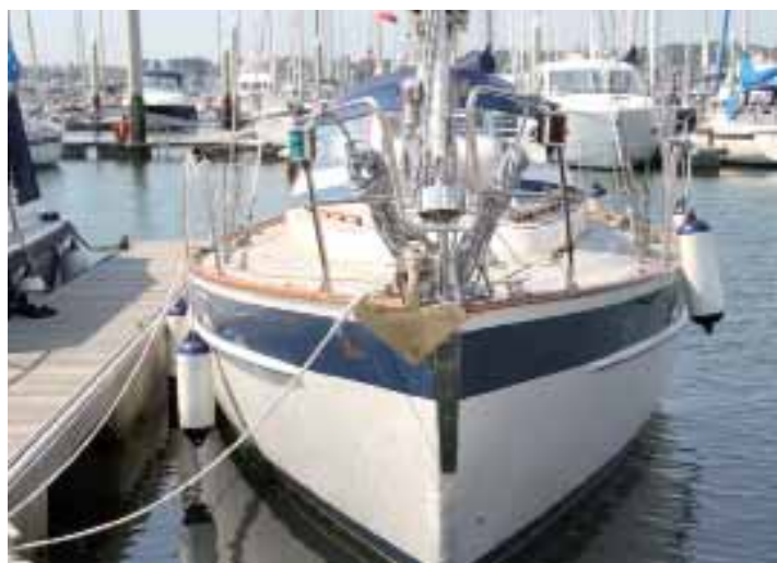
Fender auf Steghöhe auf der einen, auf Höhe der Deckskante auf der anderen Seite
