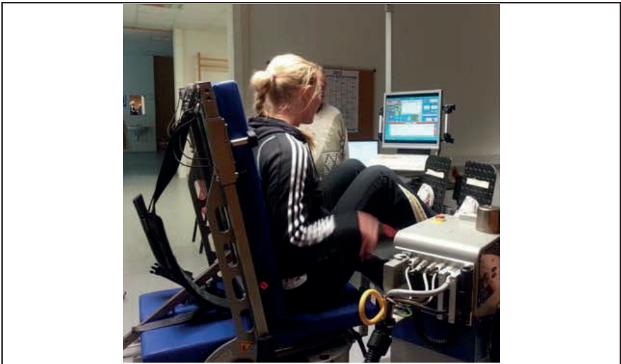
Abb. 4. Modul zur Messung der Beinstreckmuskulatur am IsoMed 2000
