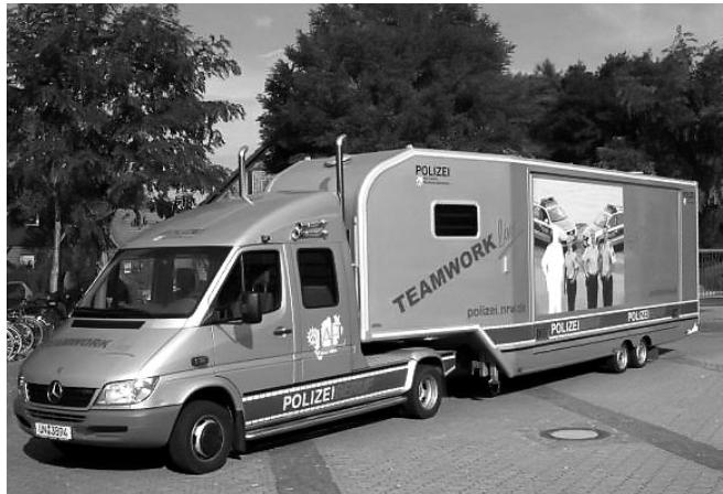
Das sog. Sattelmobil<sup>42</sup> besteht in einer Fahrzeugkombination aus einem Pickup, zugelassen als „Lkw offener Kasten“ mit versenkbarer Sattelkupplung und einem „Sattelanhänger Wohnwagen“ (auch Spezialanhänger zum Transport von Tieren u.a.m.). 0223
