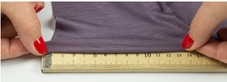
Stoff auseinanderziehen, um die Dehnfähigkeit zu prüfen
