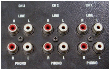
Abb. 15.12 Links: Phono-Eingänge an einem DJ-Mixer. Rechts: RIAA-Wiedergabekennlinie.
