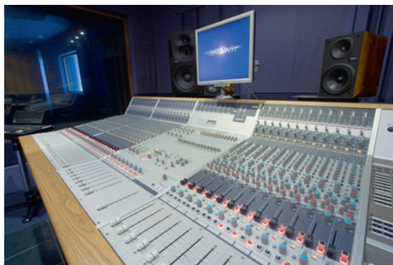
Abb. 15.6: Inline-Konsole (Audient ASP8024).
