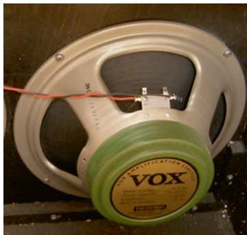
Abb. 18.2: Konuslautsprecher (Celestion G12M in einem Gitarrenlautsprecher von Vox).
