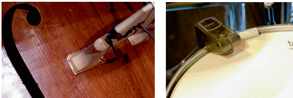
Abb. 9.10 Links: Piezotonabnehmer unter dem Steg eines Kontrabasses. Rechts: Triggermikrofon an einer Snaresdrum.
