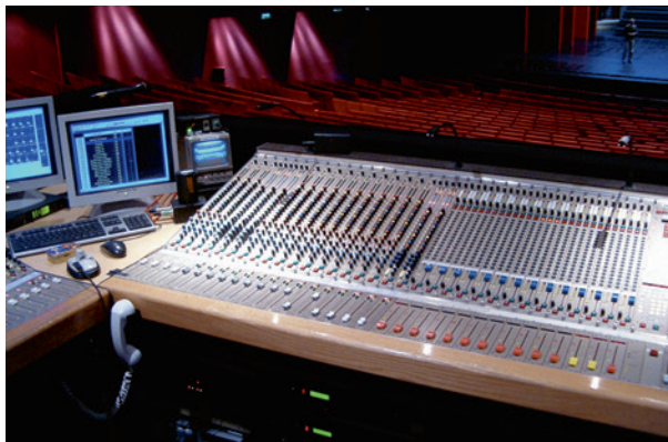
Abb. 15.7: Analoges Beschallungspult (CADAC J-Type).
