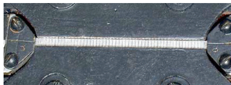
Abb. 9.3: Bändchen eines historischen Bändchenmikrofons (Siemens & Halske).
