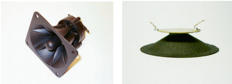
Abb. 18.9: Piezo-Lautsprecher. Links: Komplettes Hochtonhorn. Rechts: Ausgebauter Piezowandler ( \varnothing 2 cm) mit aufgeklebter Membran.
