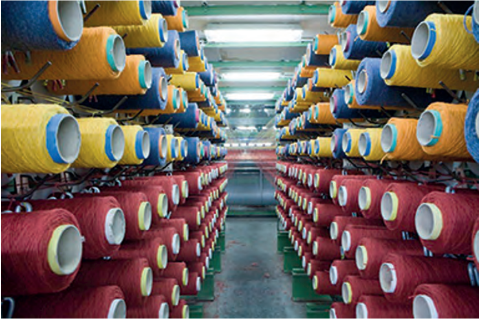
Kantergestell. Das Polgarn wird von Spulen abgezogen.
