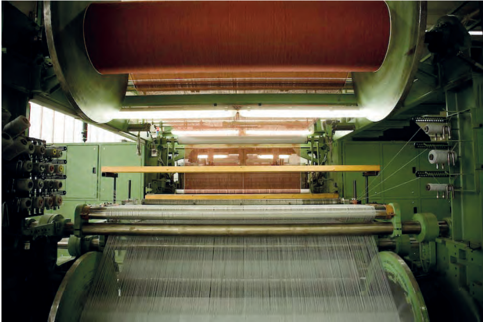
Kettbäume der Pol- und Grundkette, hinter der sich der Kettbaum der Bindekette befindet.
