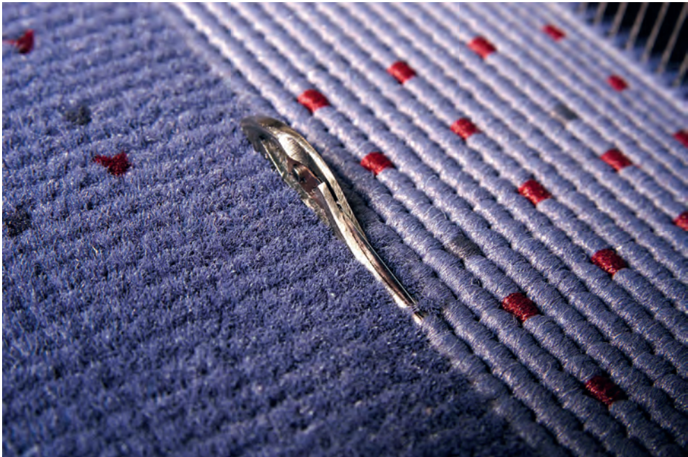
Beim Herausziehen der Schnittrute wird aus einem Bouclé ein Velours.
