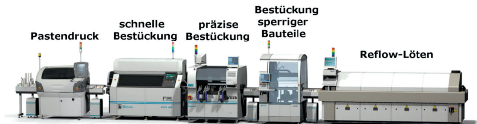
Abb. 64: Beispiel einer AART-Linie (nach Universal Instruments®)
