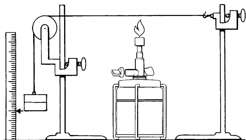
Der Versuch wird entsprechend der Skizze aufgebaut und die Unterkante der Wägestücke am Maßstab markiert. Mit dem Brenner erhitzt man den Draht, wobei eine Absenkung der Wägestücke zu beobachten ist. Durch erneutes Markieren erhält man als Differenz der beiden Marken die durch die Erwärmung des Drahtes bewirkte Längenvergrößerung. Kühlt der Draht wieder ab, steigt das Wägestück bis zur ersten Marke.
