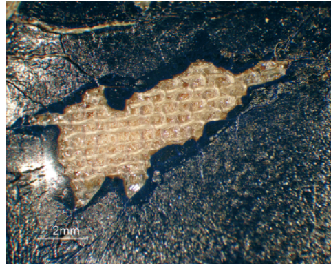
15 Fehlstelle nach dem Aufsiegeln von BEVA® 371 Film
