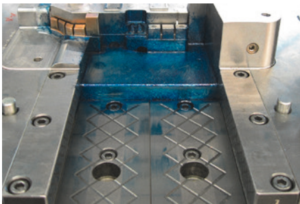
Schieberbahn mit Tuschierfarbe eingepinselt
