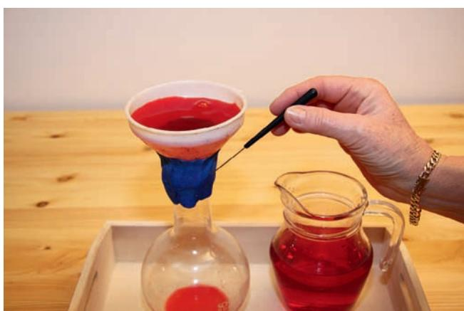
Nun bohrt die Lehrkraft ein kleines Loch in die Knetmasse, damit Luft nach außen entweichen kann.
