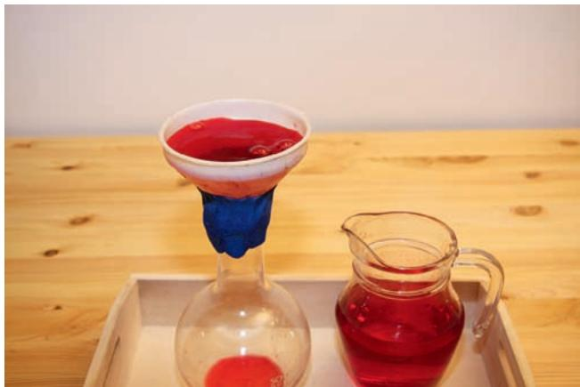
Die Lehrkraft setzt einen Trichter auf einen Erlenmeyerkolben oder ein Marmeladenglas und dichtet das Ganze mit Plastilinmasse ab. Nun gießt sie gefärbtes Wasser in den Trichter. Es ist zu beobachten, dass – obwohl das Trichterende offen ist – das Wasser nicht nach unten fließen kann; scheinbar nimmt die Luft den ganzen Raum im Glas ein und erlaubt dem Wasser nicht, dem „Gesetz Gottes“ zu gehorchen. Die Kraft der Luft ist stärker!
