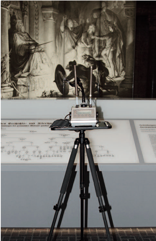
2 Aktive Probenahmen auf Tenax® TA Röhrchen bei Raumlufmessungen
